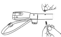
3º En algunas lanzas la perforación de la pieza de acoplamiento existente puede ser aprovechado. Mueva la conexión de la lanza WEBER en la lanza hasta que la perforación de la conexión coincida con la de la lanza. Observe Vd. que el botón de presión de la conexión de la lanza esté en el lado de afuera en dirección de la marcha. Siga Vd. directamente con el paso 5º.
