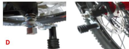
Je mittiger die Ausrichtung der Kupplung, desto besser läuft der Monoporter nach.
