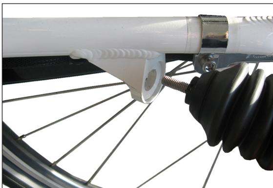
1. Die „D“ Kupplung (zur „D“irekten Montage am Fahrrad) in die Aufnahme am Rahmen einstecken.
