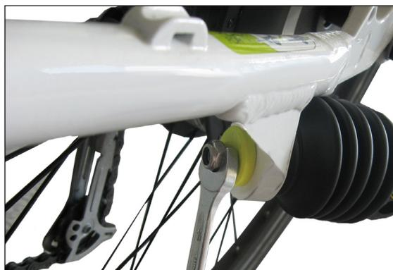
**Achtung: Eine geöffnete selbstsichernde Mutter IMMER durch eine Neue ersetzen!**
