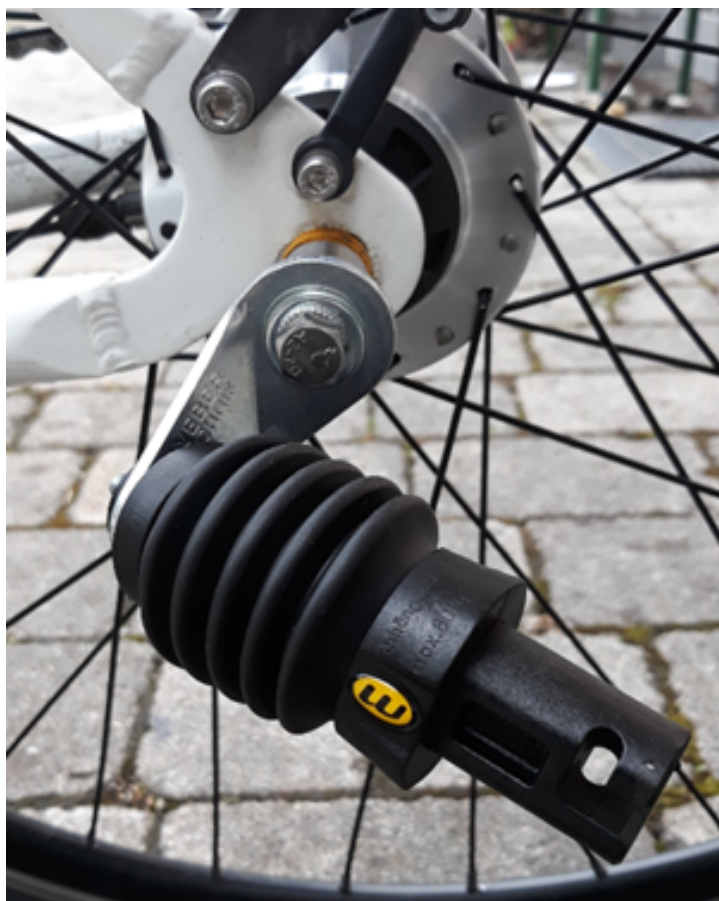
Abb. 2: Achsadapter montiert (Einbausituation)
