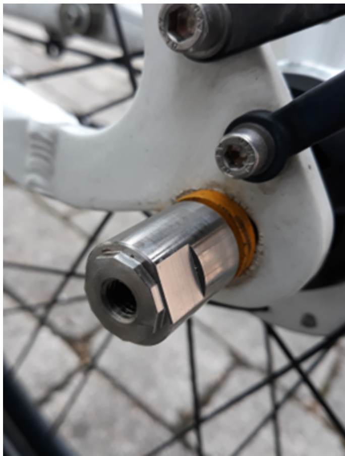
Abb. 1: Achsadapter mit Verdrehsicherung (Detailansicht)
